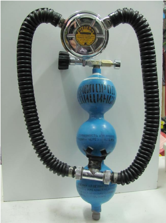
Sl.42. Da disajnu opremu i tehniku koja se koristi u avijaciji upotrebimo za ronjenje. – Iz Muzeja ronilačke opreme ovog Kluba. Kiseonička boca za ruske mlazne avione koji lete na velikim visinama.
