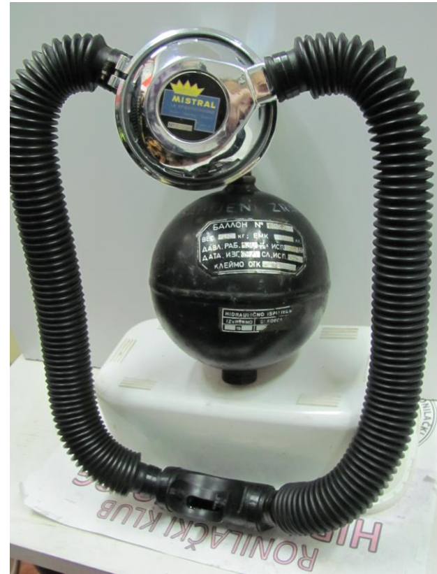
Sl.43. Da opremu koja se koristi u ratnoj avijaciji upotrebite kao disajnu ronilačku bocu na koju se mogu montirati ronilački regulatori – Loptasta boca za helikoptere od 2 litra zapremine na 135/190 bara za vazduh – Muzej ovog Kluba.
