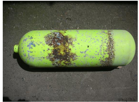
SI.19. DA U NOVOJ GODINI PAZITE NA VAŠU RONILAČKU OPREMU I TEHNIKU: Sponginozna elektrokorozija boce.
