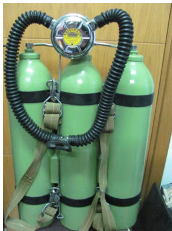
Sl.44. Da i vi se setite ronjenja tokom odsluženja vojnog roka u RM kada ste ronili sa aluminijumskim trobočnim aparatom od 3 x 6,8 litara na 175 Bara sa montiranim Mistral Standardom. – Muzej ronilačke opreme ovog Kluba.
