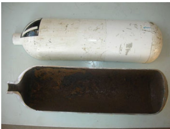
SI.17. DA U NOVOJ GODINI PAZITE NA VAŠU RONILAČKU OPREMU I TEHNIKU: Sponginozna korozija unutrašnjosti male boce.
