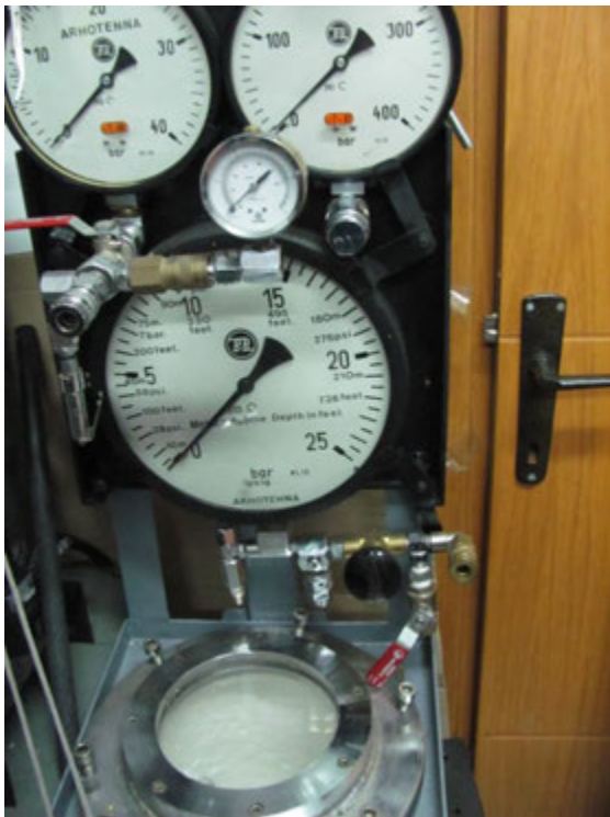
SI.20. DA ZA SERVIS RONILAČKE OPREME I TEHNIKE IMATE: Dovoljno instrumenata – Komora za proveru rada regulatora u vodi pod pritiskom dubine.
